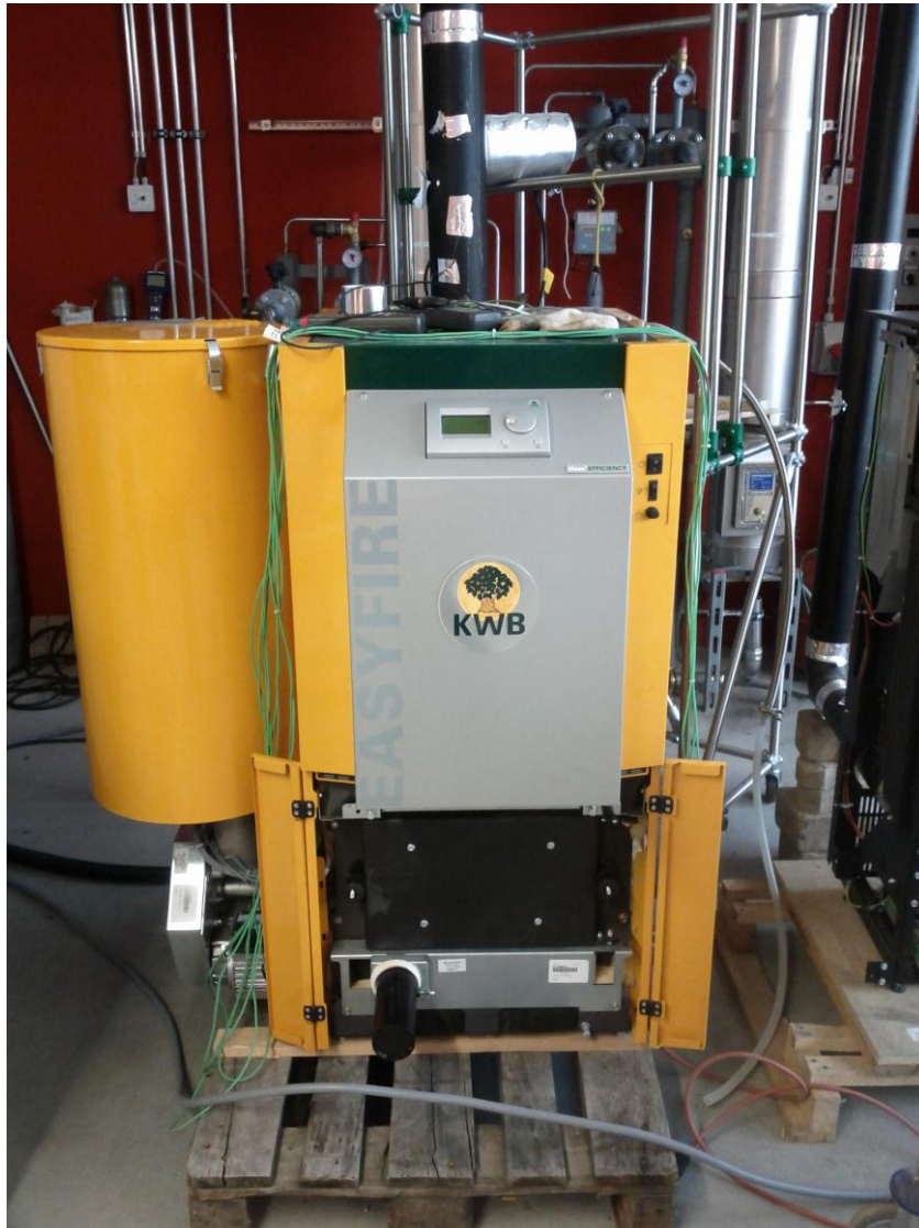
Abb. 10: HFR-Zentrallabor, Ofenraum mit modifiziertem KWB-Pelletbrenner, Projekt COFIT
